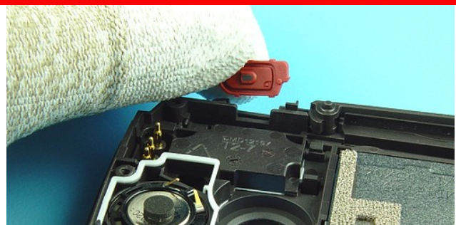
22) Remove the Power Key .
